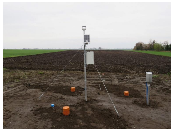
Automatyczna stacja meteorologiczna z transmisją danych
