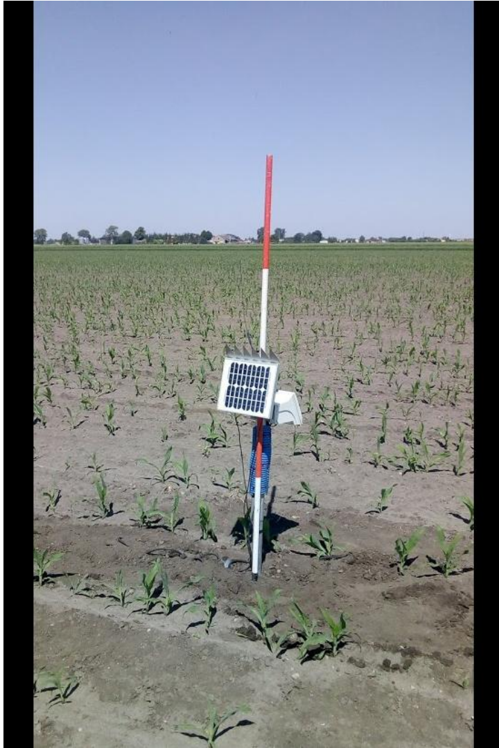
Automatyczny zestaw do pomiaru wilgotności gleby zainstalowany na polu kukurydzy (Krusza Duchowna, 7.VI.2021 r.)
