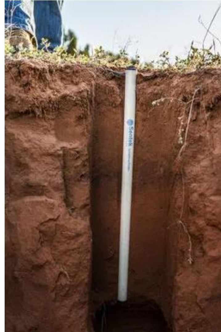
Sonda wilgotności gleby (źródło: https://www.inmtn.com/agriculture/soil/sentek )
